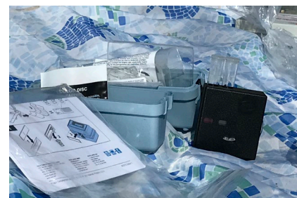
Figura 11: Strumentazione per la misura del contenuto di nitrati. © Daria Lehmann / GLOBE Svizzera
