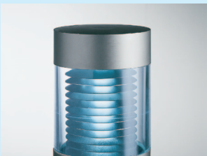
Les bornes lumineuses munies d'une grille de défilement horizontale diffusent beaucoup moins de lumière vers le ciel. Ce type d'éclairage n'est toutefois pas idéal en termes de sécurité et de consommation d'énergie.
